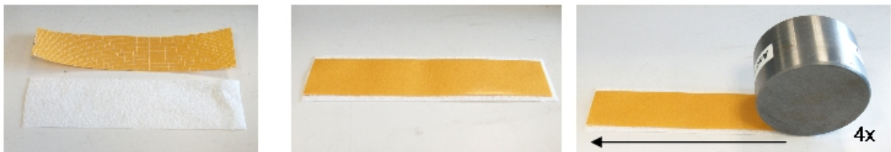
Bild 4 – Herstellung Verbund Vlies und Klebeband
