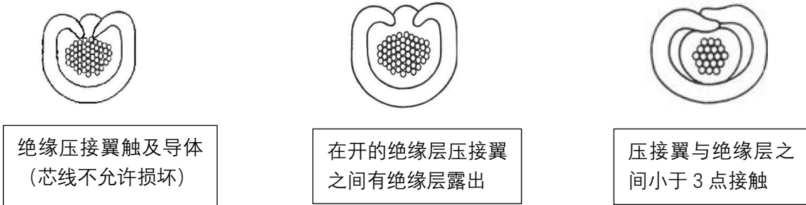
图 4.3.5-3B – 可接受但不理想的绝缘压接
