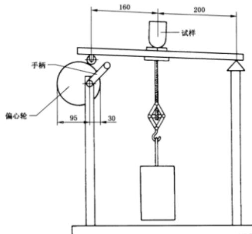
图 6 电缆固定部件试验装置
