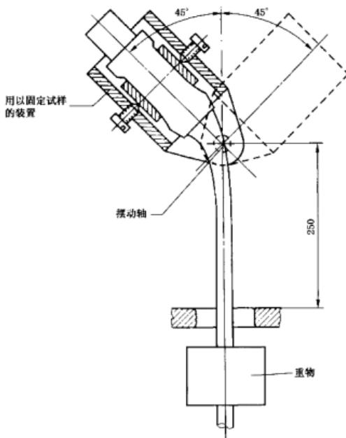
图 9 弯曲试验装置
