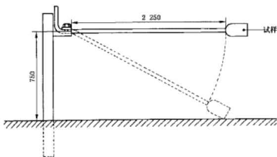
图 8 插头和连接器机械强度试验的配置
