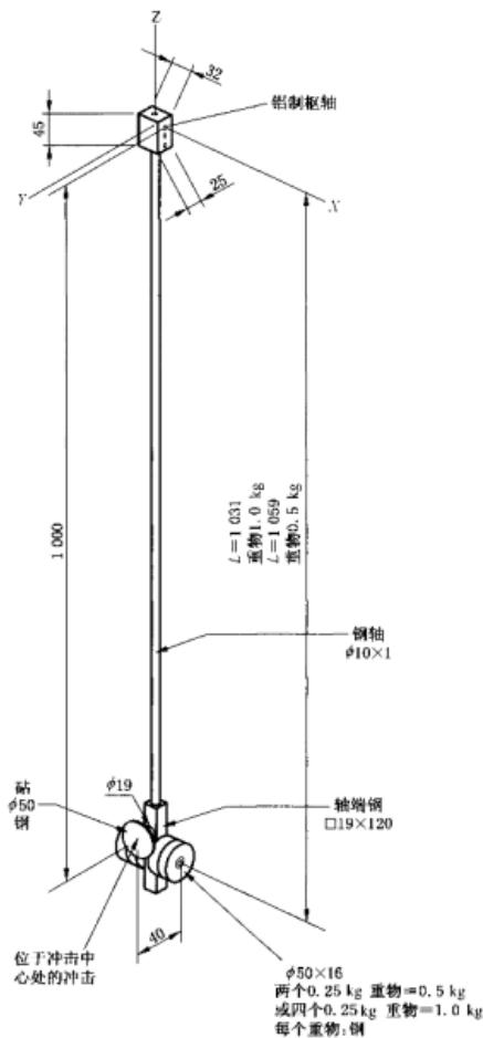
图 A.1 冲击试验装置——摆锤组件
