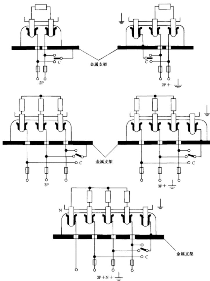
图 5 分断能力和正常操作试验电路图
