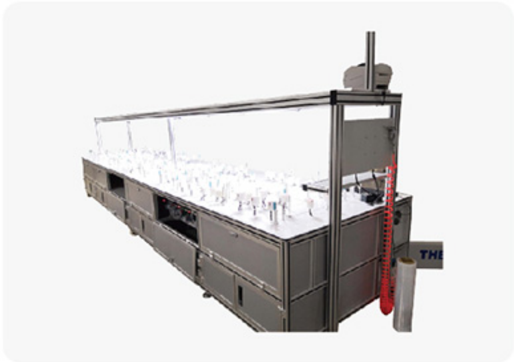
CSA Cable Tie Testing Table
